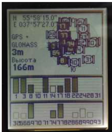
Рис. 8.10. Просмотр доступных на горизонте спутников и доступности их сигналов
