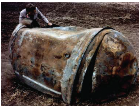
Рис. 9.3. Главный топливный бак второй ступени ракеты-носителя «Дельта-2» после падения близ Джорджтауна, штат Техас (США) 22.01.1997 г.
