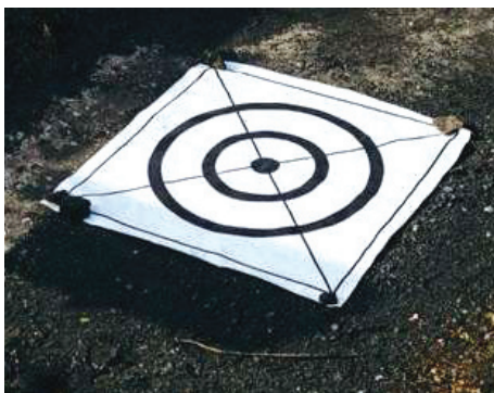
Рис. 3.12. Плоский радиальный опорный знак на нетвердой основе
